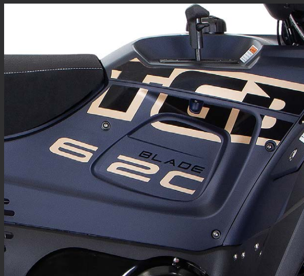
TRAPPE D'ACCÈS AU RADIATEUR À DÉMONTAGE RAPIDE
