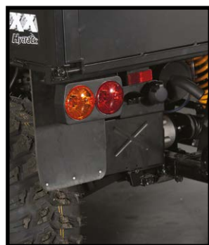
BAVETTES DE PROTECTION Contre les projections de boues sur les roues arrière.
